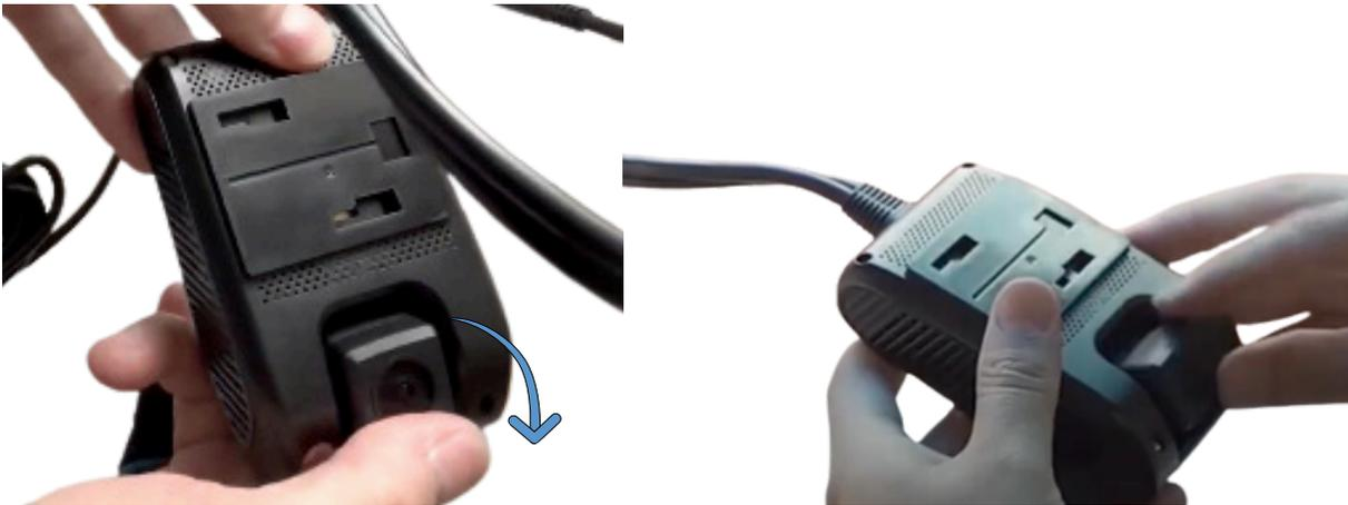
11 - Fixez la caméra sur son support de montage et ouvrez l'ignition du véhicule.
