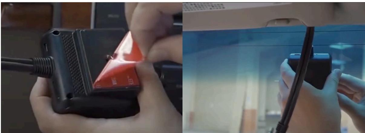
8 - Détachez la caméra de son support de montage et appliquez une pression ferme pour garantir une surface de contact plane, assurant ainsi une adhérence optimale du ruban adhésif 3M.
