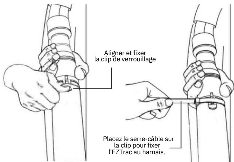
4. Veillez à aligner et à fixer le clip de verrouillage entre le faisceau ABS et la connexion du dispositif EZTrac. Placez un (1) collier de serrage sur la clip de verrouillage pour éviter que la connexion ne se sépare.
