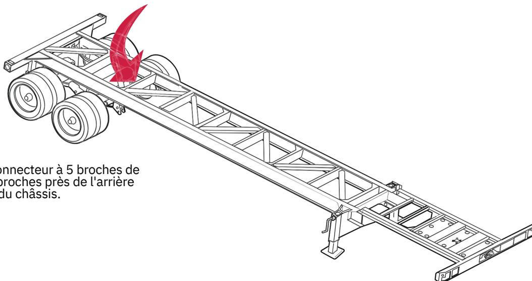
1. Localisez le connecteur à 5 broches de l'ABS TTMA à 5 broches près de l'arrière de la remorque/du châssis.
