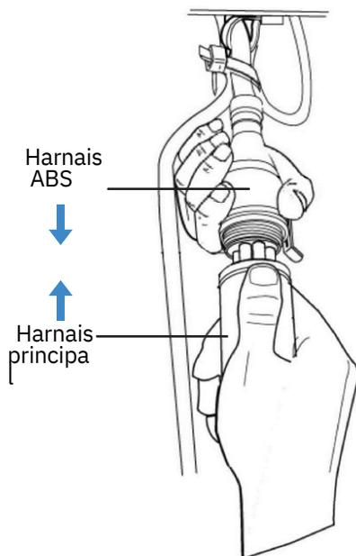
4. Veillez à aligner et à fixer le clip de verrouillage entre le faisceau ABS et la connexion du dispositif EZTrac. Placez un (1) collier de serrage sur la clip de verrouillage pour éviter que la connexion ne se sépare.
